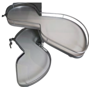
Lemans Hidastimella varustettu piilkokulmamekanismi Hyllyjen kantavuus 25 kg / hylly Oven minimileveys 395 mm
